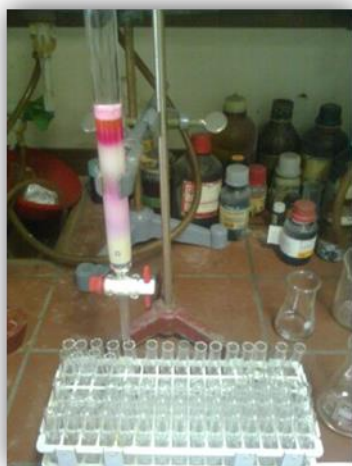
Slika 28. Razdvajanje hlorovanih proizvoda na hromatografskoj koloni (levo); razdvajanje frakcija na tankom sloju \text{SiO}_2 (desno).
