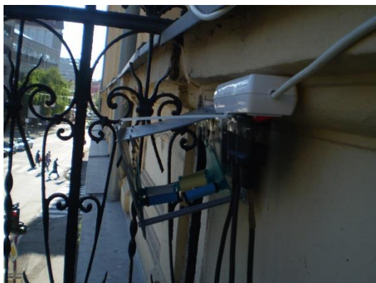
Slika 4. Uzorkovanje pasivnim uzorkivačima u spoljašnjoj sredini (levo) i unutrašnjem prostoru (desno).
