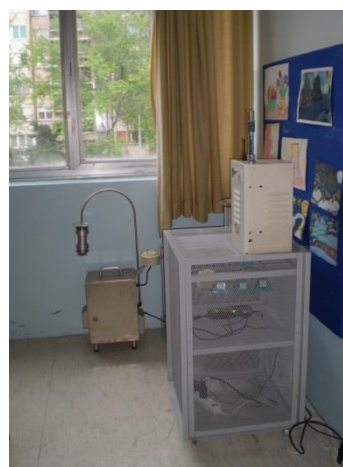
Slika 5. Uzorkovanje u unutrašnjem prostoru pomoću Leckel pumpi (levo) i OSIRIS uređaja (desno).
