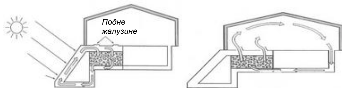
Slika 2. Pasivno solarno grejanje prostora sa akumulatorom toplote ispod grejanog objekta [5]
