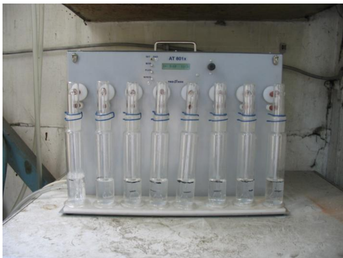
Slika 1 – Uzorkivači vazduha „Proekos“ AT-801x i „Glass Developments“
