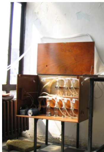
Slika 1 – Uzorkivači vazduha „Proekos“ AT-801x i „Glass Developments“
