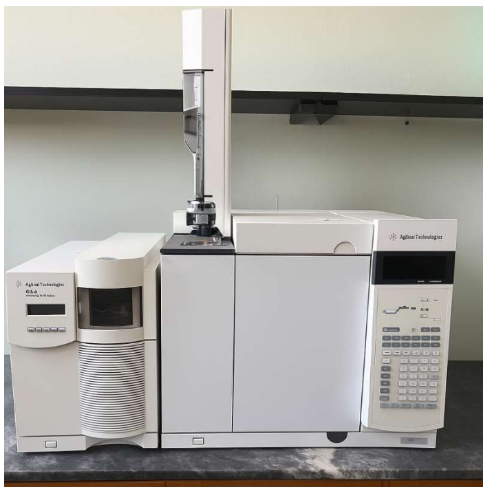
Слика 26. Гаснохроматографско-масеноспектрометријски систем Agilent 7890A GC - Agilent 5975C MS.
