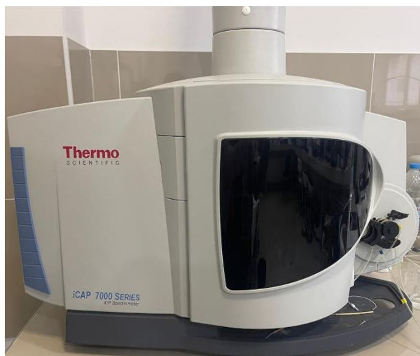
Слика 7. Thermo Scientific iCap 7400 duo ICP-OES инструмент (Thermo Fisher Scientific, Велика Британија).
