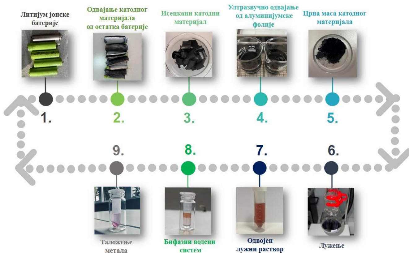
Слика 9. Шематски приказ интегрисаног процеса издвајања метала из катодних материјала ЛЈБ.
