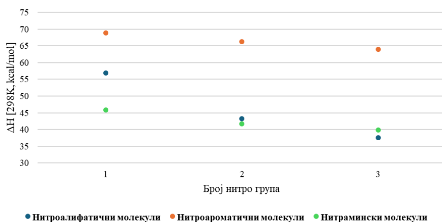
Слика 29. Утицај повећања броја нитро супституената на енталпију дисоцијације C-NO 2 и N-NO 2 везе; енталпија дисоцијације C-NO 2 или N-NO 2 веза су израчунате B3PW91 методом и 6-31++G(3d,2p) базним скупом.
