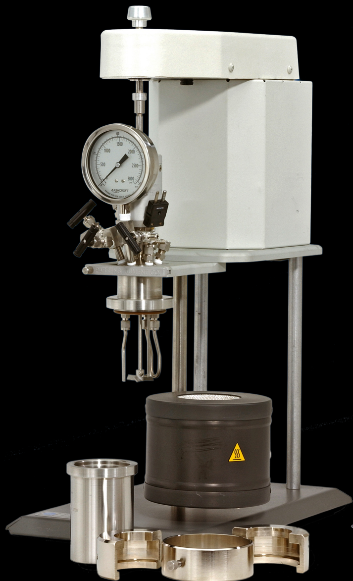
A. METALNI AUTOKLAV, RASKLOPLJEN (DO ~ 200 atm, 250°C)
